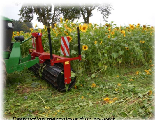
Destruction mécanique d'un couvert
