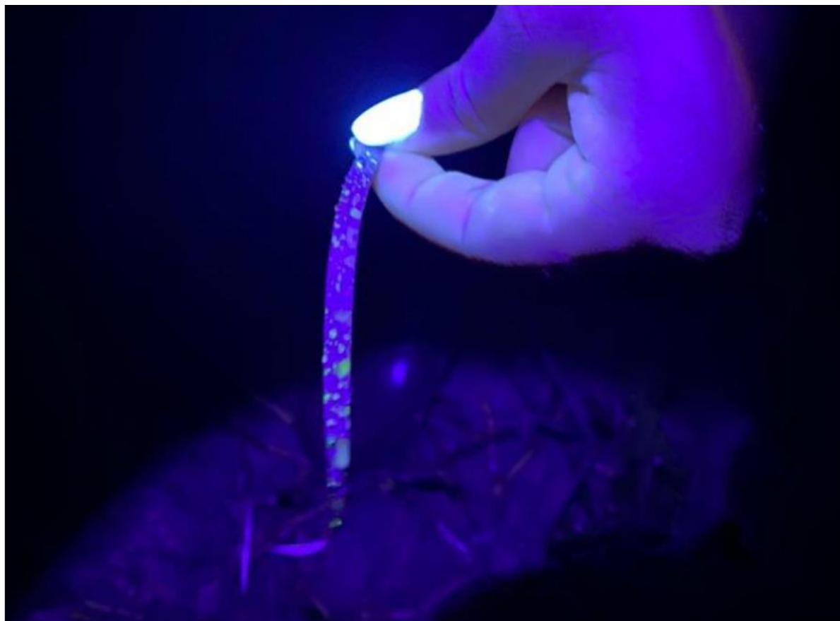
En plus d'être jolie à voir, l'expérience permet de déterminer l'homogénéité de la pulvérisation. © Groupe carré
