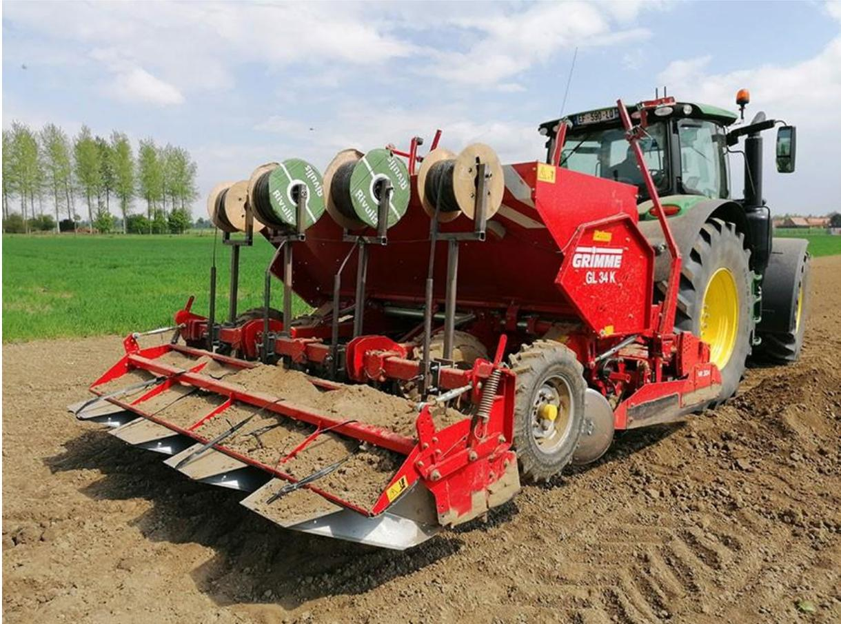
**Planteuse de pommes de terre équipée de dérouleuse de gaines micro-irrigation (bricolage accessible aux agriculteurs)
