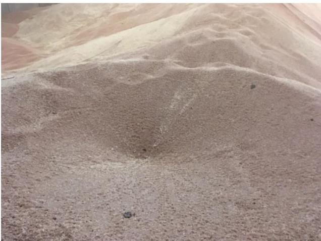
**Diagnostic :** infiltration de grains dans la gaine de ventilation : gaine bouchée
